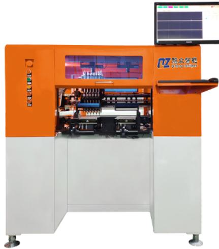
贴合机对于屏幕贴合来说，无法除泡或者气泡反弹是很麻烦的事情，不断的返工，寻找原因，这些问题就会不断困扰着我们，特别是对于新手来说，气泡反弹真的让人无从下手，到底该怎么解决呢?贴合机出现气泡反弹怎么办?质量不好的oca含有很多杂质，本身的性质很不稳定，甚至天气的忽冷忽热都会对贴合效果产生影响。不要认为贵的就是好的，不多解释。一般建议不超过35℃。高温会使oca胶空气溶解度变大，恢复到常温环境oca空气溶解度降低气泡就会反弹出来。如果除泡压力过大时间过长，在高压环境中可能使一些操作不当产生的本不能除掉的气泡强行除掉，恢复到正常压力环境后气泡会反弹出来。对位屏幕盖板时过度过多的人为按压屏幕，使屏幕贴合前产生很多细小的死泡，这样的情况贴合后即使除掉气泡也很可能会造成气泡反弹。在贴合有的国产屏幕时边角气泡反弹是因为国产屏幕一般触摸屏集成在盖板上面，在盖板边缘会集成很多线路。这些线路会使盖板边缘的厚度变的不均匀产生高度差，如果使用薄的oca贴合屏幕后很容易出现气泡弹情况，建议使用厚度大的oca贴合。
